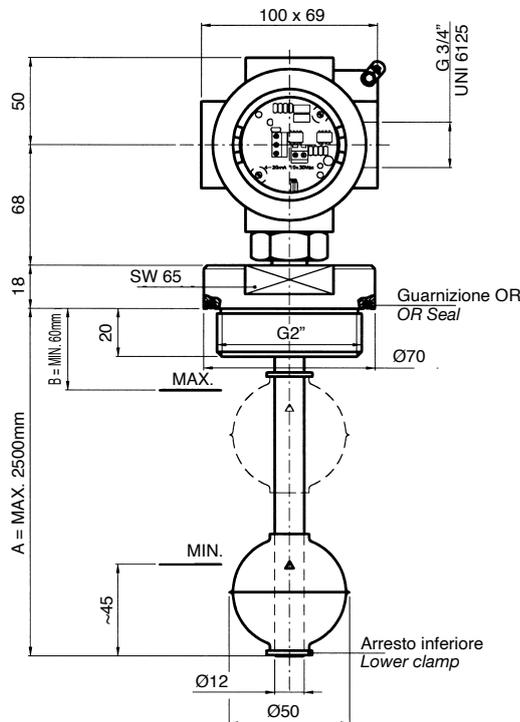
Le sonde di livello SL2TIA...B...CVS3EP con convertitore di segnale 4/20 mA sono state concepite per controllare in continuo il livello di un liquido contenuto in un serbatoio di stoccaggio.
