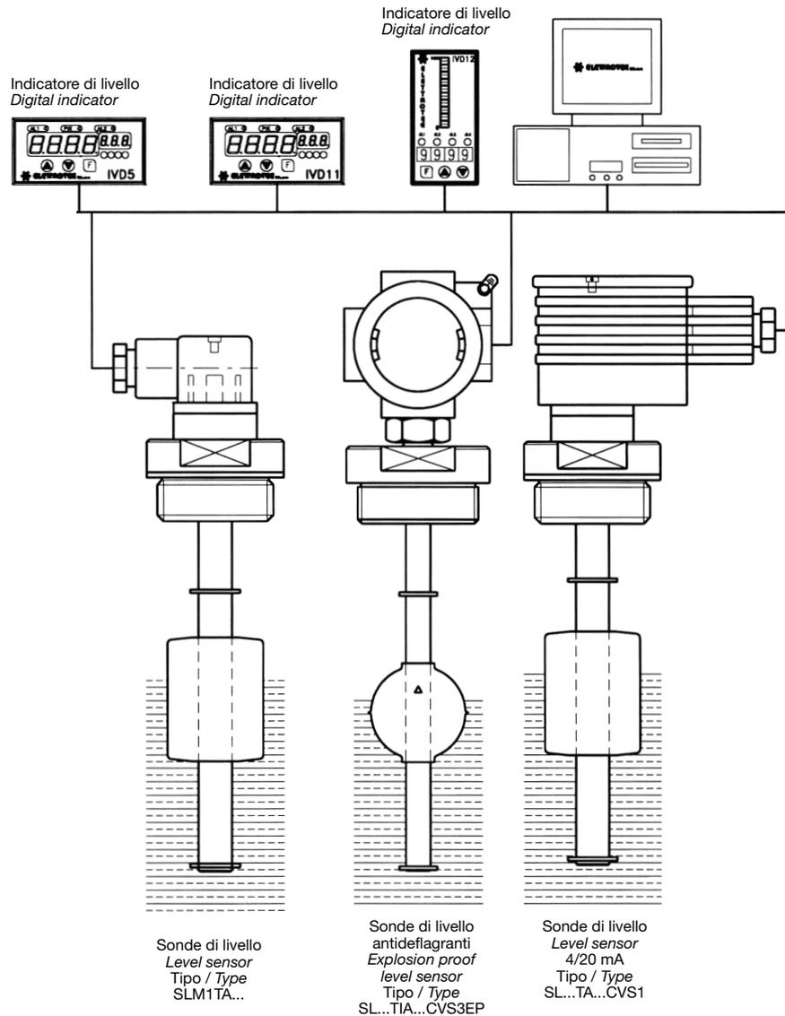
Le sonde di livello Elettrotec sono state ideate per controllare il livello di un liquido.
