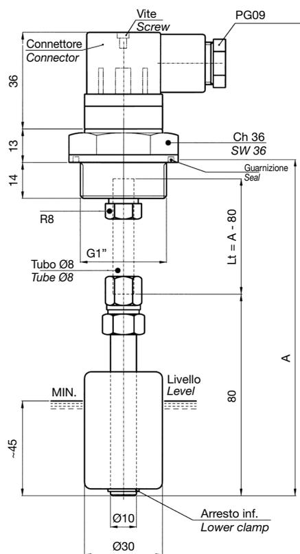
**MATERIALI:** flangia in termoplastico, corpo in ottone, bocchettone BCH8 e anello di serraggio ANS8 in ottone, galleggiante in resina espansa NBR.
